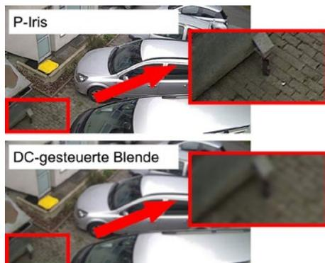
Bei normalen DC-gesteuerten Blenden wird das Bild bei geringer Blendenöffnung durch die Strahlenbeugung am Rand der Blende oft unscharf. Dieses Problem tritt besonders bei Megapixel-Sensoren mit sehr kleinen Pixeln auf.
